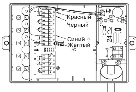
В интервалах между импульсами выходное напряжение, применяемое для питания прибора MULTICAL® типа 66-CDE составляет ок. 24 V. Отрицательный импульс улавливается модулем и передается на вход расходомера на клеммы 10 - 11.
