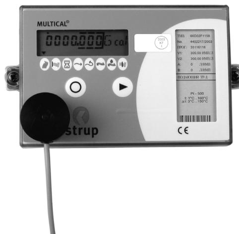
Оптическая головка представляет собой оптимальное решение в сочетании с переносным компьютером. Напр., можно просто и быстро ввести в программу новые предельные тарифные значения, не прерывая вычисления энергии. В случае наличия в составе MULTICAL® типа 66-CDE встроенного коммуникационного модуля, напр. канала M-Bus или LonWorks, возможность программирования оптическим путем может быть отключено самим прибором. В таком случае для программирования рекомендуется применять поверочное оборудование.
