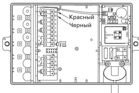
Сетевое питание 230 V переменного тока подсоединяется к клеммам 27 и 28. Заземление не применяется, поскольку MULTICAL® с модулем 230 V перем. тока имеет двойную изоляцию.
