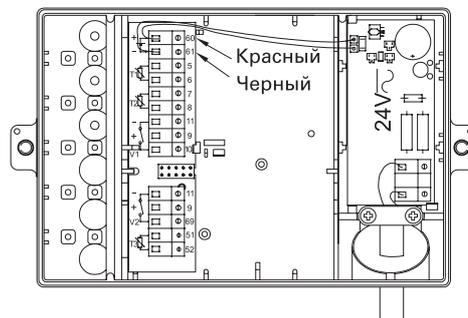
Подсоединенный источник прямого или переменного тока напряжением 24 V должен быть изолирован от сетевого напряжения. Трансформатор 230/24V для монтажа на DIN-шине или панели имеет тип № 66-99-400.
