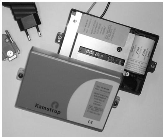
Поверочное оборудование поставляется одного из 3-х типов, в зависимости от версии применяемого MULTICAL® и температурных точек, подлежащих тестированию.
